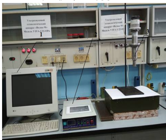
1 – компьютер; 2 – прибор управления ультразвуковым генератором по месту; 3 – ультразвуковой генератор
